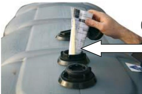
Ce document se trouve dans un cylindre en plastique situé dans le 2ème orifice du réservoir.
